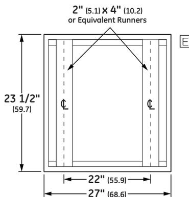
INSTALLING ANTI-TIP BLOCKS
